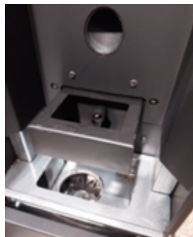
Figure 39 - Vue sur turbine moteur fumées
