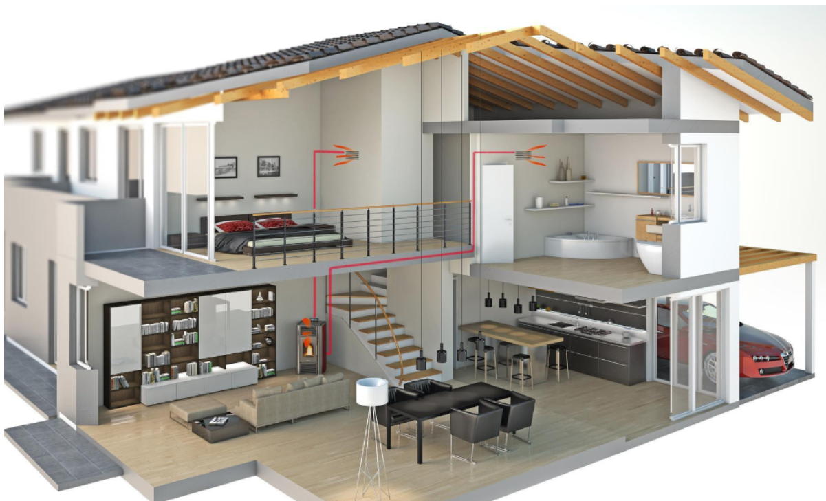
Figure 13 - Exemple de canalisation
