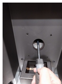
Figure 25 - Nettoyage avec nettoie-pipes
